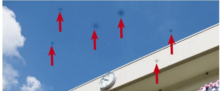
左の矢印で示しているものがイメージセンサーに付着したゴミによって影響を受けた箇所です。
